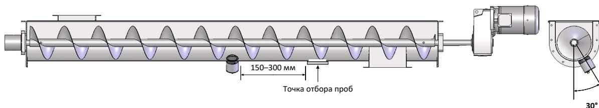
Рисунок 8: Монтаж на шнековом конвейере
