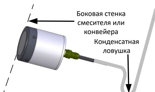
Рисунок 16: Датчик Hydro-Mix с конденсатной ловушкой
