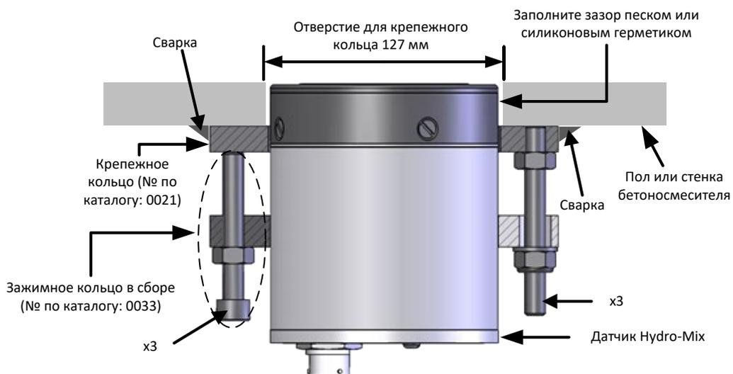
Рисунок 11: Монтаж датчика
