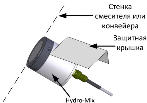
Рисунок 17: Датчик Hydro-Mix с защитной крышкой
