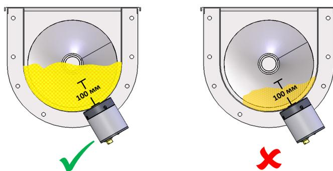
Рисунок 9: Уровень материала на шнековом конвейере
