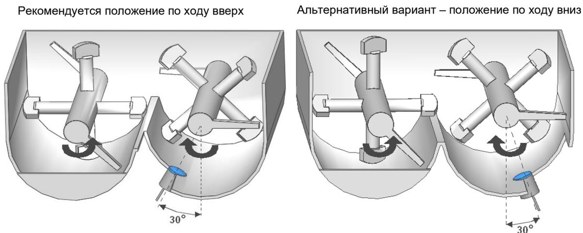
Рисунок 7: Монтаж в двухвальном бетоносмесителе
