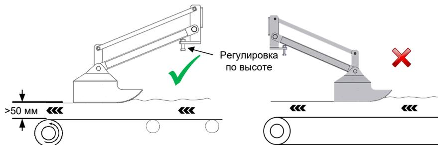
Рисунок 10: Монтаж датчика Hydro-Skid на ленточном конвейере
