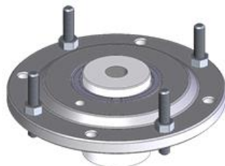
Рисунок 24: Установка крепежных штифтов
