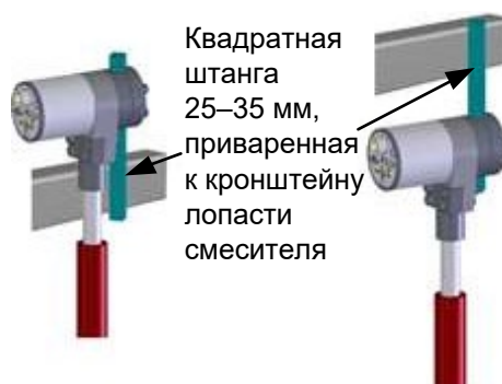
Рисунок 6: Крепление датчика над или под кронштейном лопасти смесителя
