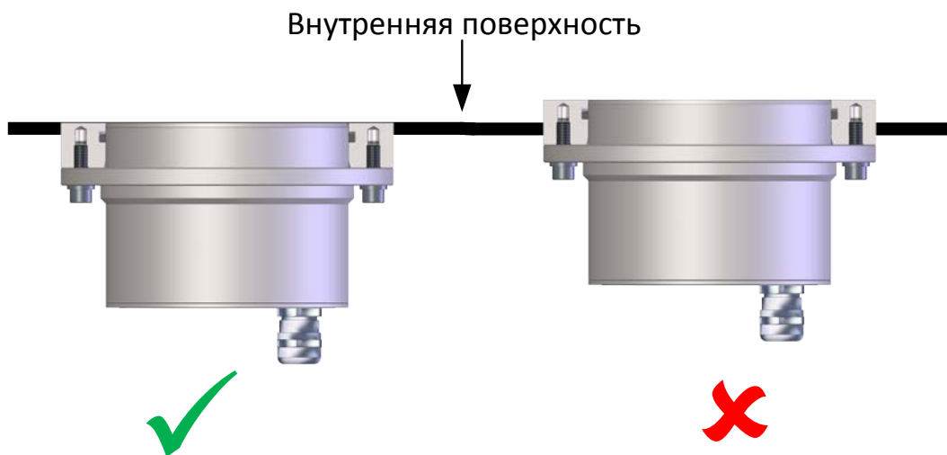
Рисунок 2: Установка на плоской поверхности
