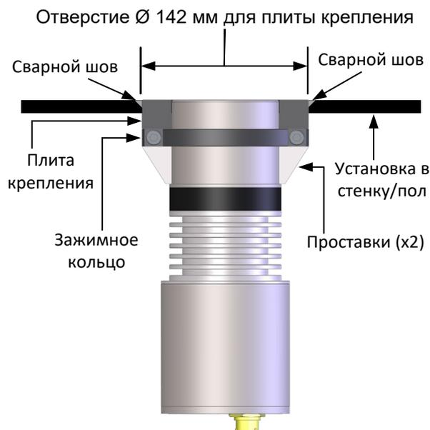
Рисунок 11: Установка датчика (монтаж плиты крепления заподлицо)
