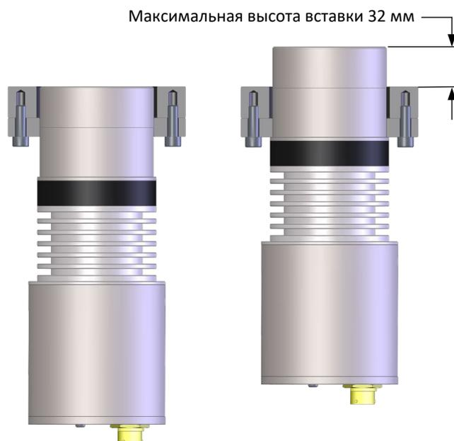
Рисунок 18: Вставка с минимальной и максимальной высотой
