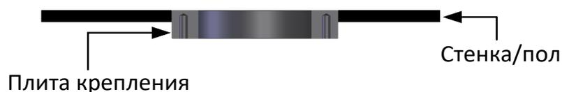
Рисунок 22: Монтаж плиты крепления заподлицо
