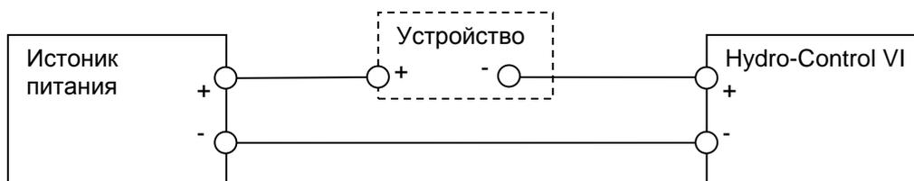
**Рис. 13: Подключение устройства с питанием от контура**
