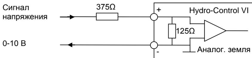
**Рис. 15: Подключение к аналоговому входу сигнала напряжения**
