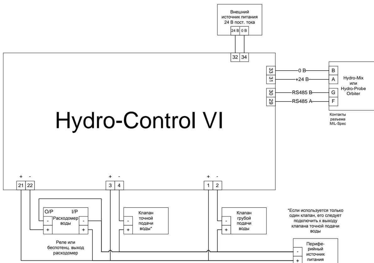
Рис. 40: Пример схемы соединений для ручного управления установкой
