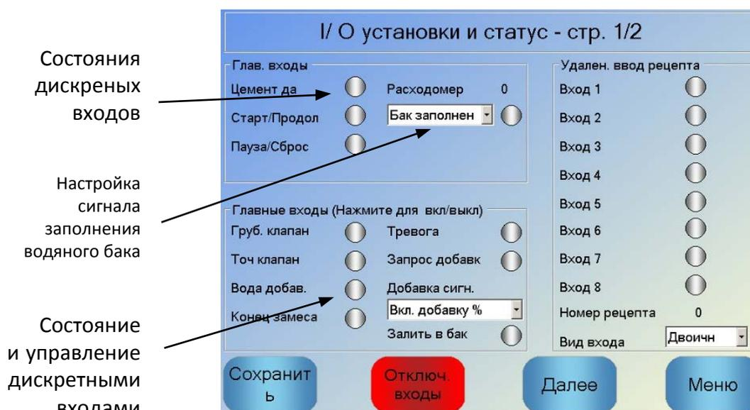
**Рис. 19: Экран настройки и состояния входов/выходов – Страница 1**
