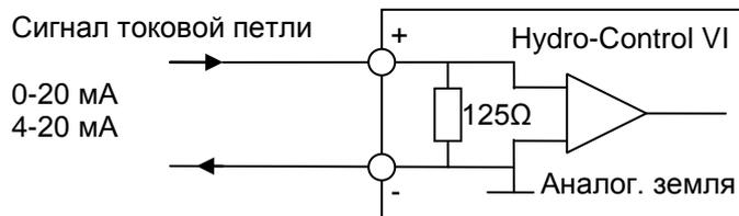
**Рис. 12: Схема подключения аналогового входа с токовым контуром**
