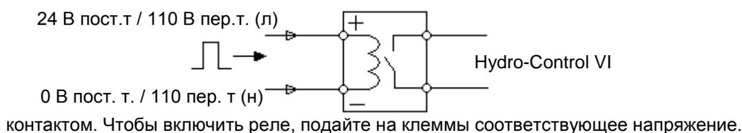
Рис. 10: Схема подключения дискретного входа
