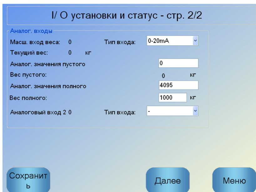
**Рис. 20: Экран настройки и состояния входов/выходов – Страница 2**
