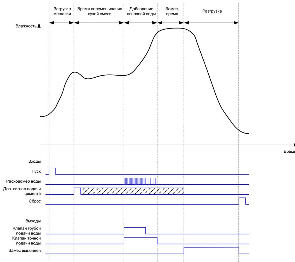
**Рис. 43: Простой цикл замеса с демонстрацией состояния входов/выходов**
