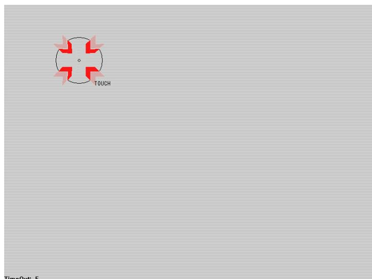
**Рис. 22: Пример экрана калибровки с целевой областью**
