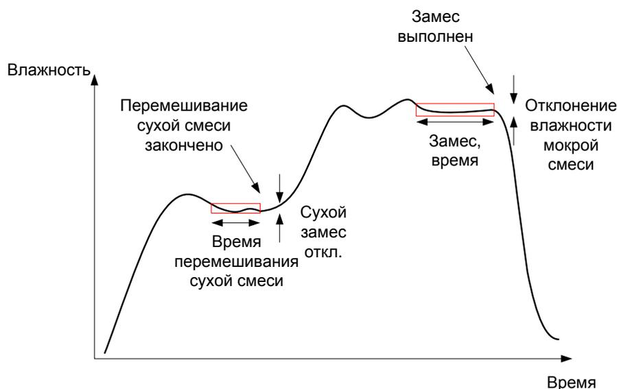
**Рис. 46: График замеса, демонстрирующий настройки автоматического слежения**
