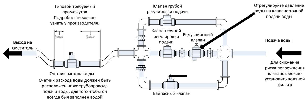
Здесь приведен вариант схемы установки. Подробности см. в руководствах производителей.
