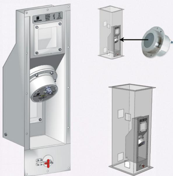
Компания Hydronix разработала систему трубопроводов для датчика Hydro-Mix XT. Она позволяет легко установить датчик в правильном положении для достижения наиболее точных результатов измерения влажности. Hydronix рекомендует использовать систему в любых трубопроводах, так как она обеспечивает удобную поддержку Hydro-Mix XT.
