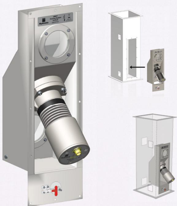
Компания Hydronix разработала систему трубопроводов для датчика Hydro-Mix HT. Она позволяет легко установить датчик в правильном положении для достижения наиболее точных результатов измерения влажности. Hydronix рекомендует использовать систему в любых трубопроводах, так как она обеспечивает удобную поддержку Hydro-Mix HT.
